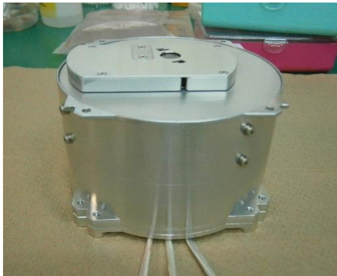
膜収納時外観(Φ110mm×75mm)
