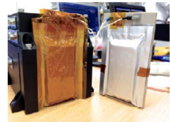
関西大学石川教授らが開発したイオン液体リチウム二次電池（写真上）ほどよし3号機技術実証モジュールに搭載されたイオン液体リチウム二次電池。簡素なラミネート外装のみにもかかわらず、超高真空下での作動が可能となります。（写真下）
