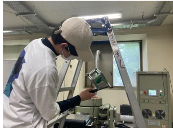
インパクトハンマーによる固有振動数の測定
