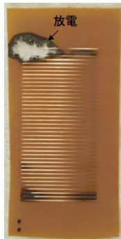
放電した試験サンプルと放電の様子
