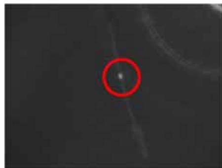
ひび割れ部での電流収集による発光
