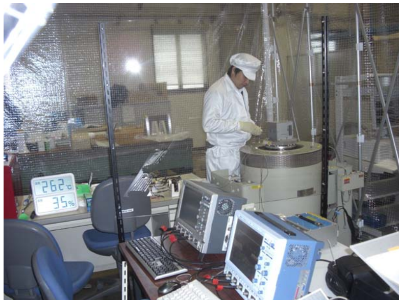
鹿児島衛星プロトフライトモデルの振動試験準備作業
