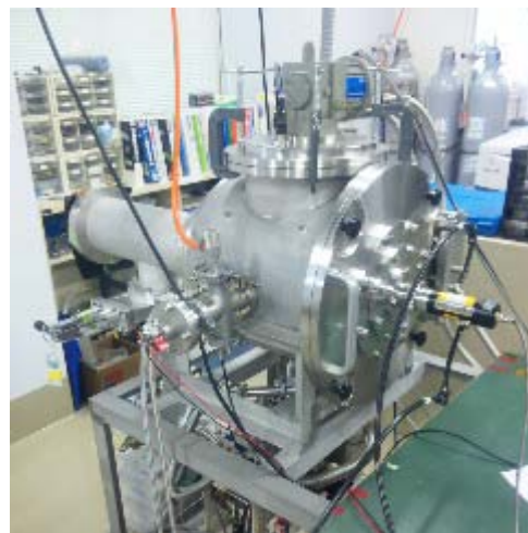
汚染物付着プレートを新設した 新紫外線チャンバー
