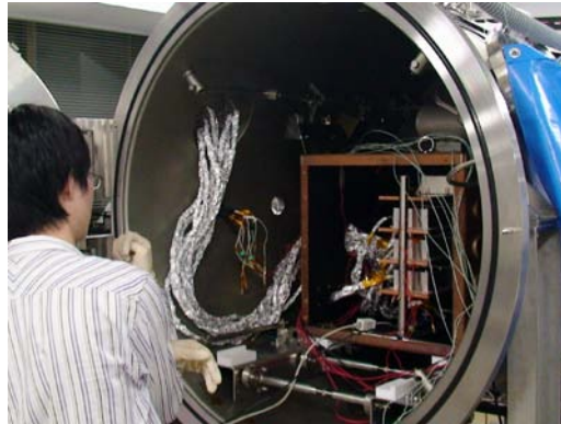
UNITEC-1 UOBC 熱真空試験の様子
