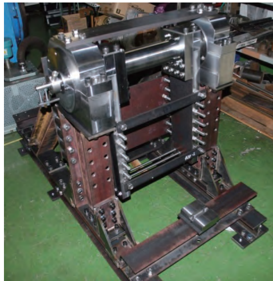
図4 開発した振り子式運動量計測装置
