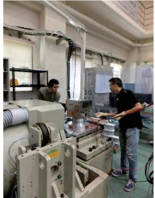
熱構造モデルの振動試験風景
