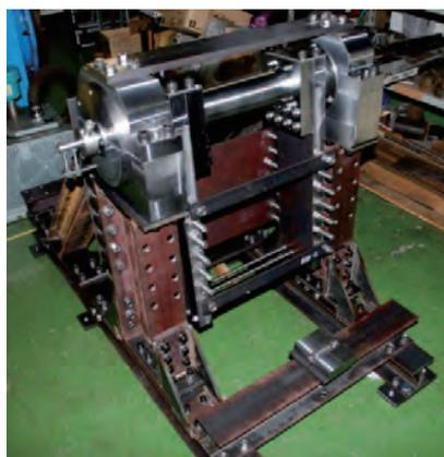
図 4 開発した振り子式運動量計測装置
