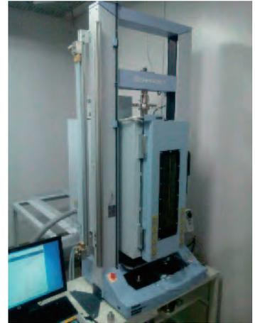
万能試験機用恒温槽
