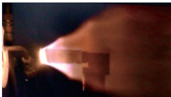
超軽量熱防御材料アブレータ LATS の高エンタルピ流加熱試験 (JAXA)
