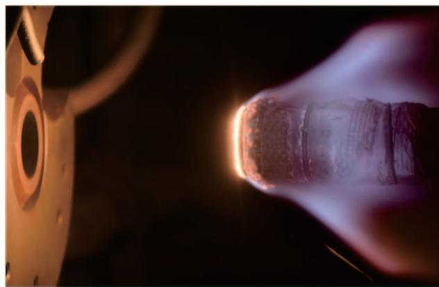
熱可塑CFRTPを表層に、LATSを裏層にした複合型アブレータの加熱試験の様子
