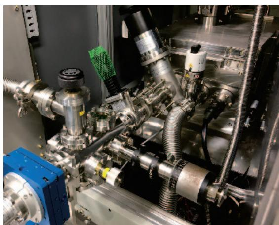
電子線照射装置に取り付けた搬送機構のプロトタイプ
