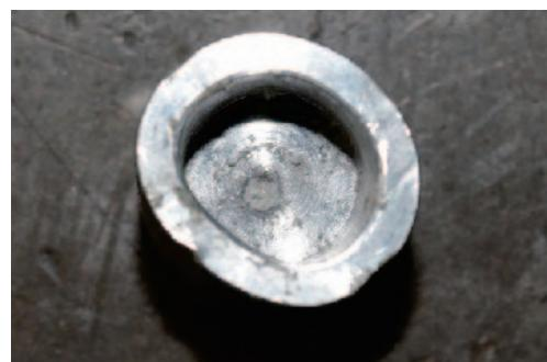
図 8 衝突後軟回収したターゲット飛翔体
