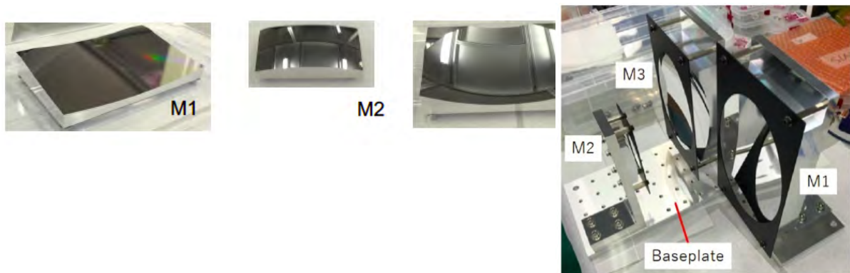
アルミニウム合金製非球面ミラーとミラーアセンブリ( http://dx.doi.org/10.1117/12.2559169 )
