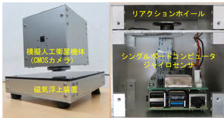
磁気浮上装置を用いた姿勢制御実験
