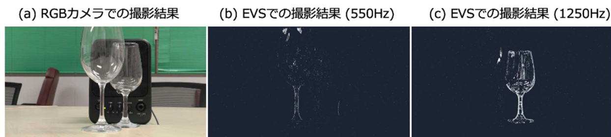
図 4. EVS でワイングラスの共振を撮影した例
