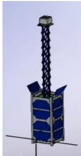
図： 開発中の 2U-CubeSat の概念図
